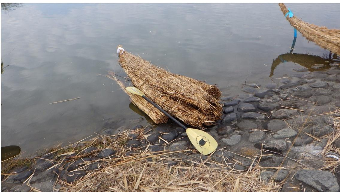
回転性を重視した短い舟体。サイドフロートで安定性を確保するねらい。斬新な設計だが、浮力不足はいなめず。
